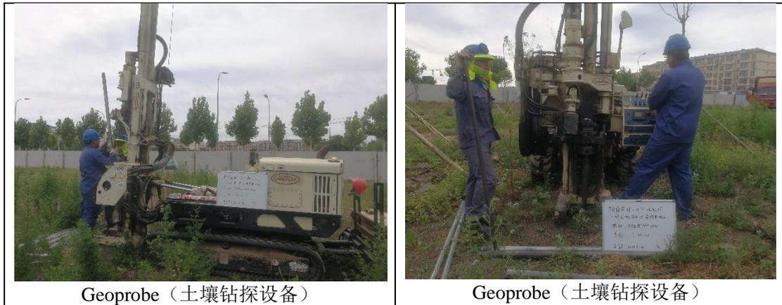
图 4-6 钻探采样设备
