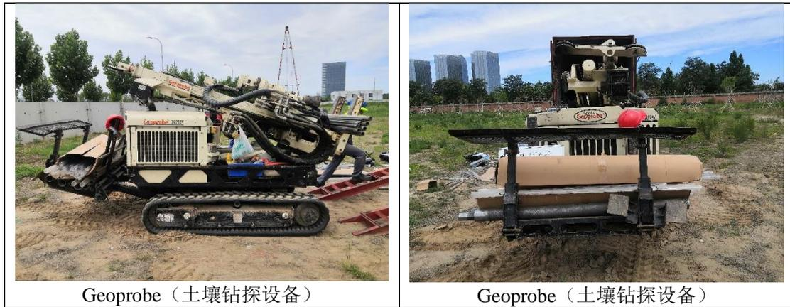
图 4-7 钻探采样设备
